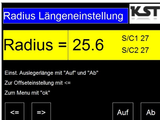
Einstellung der Länge wie oben bei möglichst flachem Auslegerwinkel.
