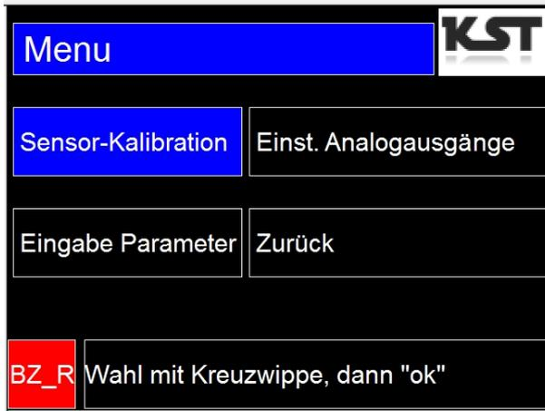
**Hinweis:** Der Menüpunkt „Einst.Analogausgänge“ kommt nur bei HBC-1 Systemen, welche über einen Analogausgang verfügen.
