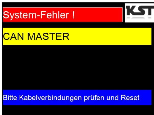
In diesem Fall einen Neustart (Spannung aus und nach einigen Sekunden wieder an) versuchen. Die Verdrahtung der CANBUS Verbindung in der Zentralbox prüfen und Neustart. Ansonsten kann nur der Kundendienst diesen (sehr unwahrscheinlichen) Fehler beheben.
