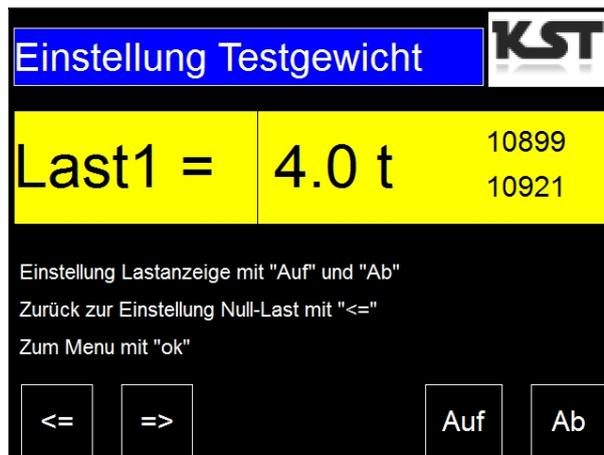
Der Kran wird hierzu mit einem bekannten Testgewicht belastet, welches so schwer wie möglich sein sollte.
